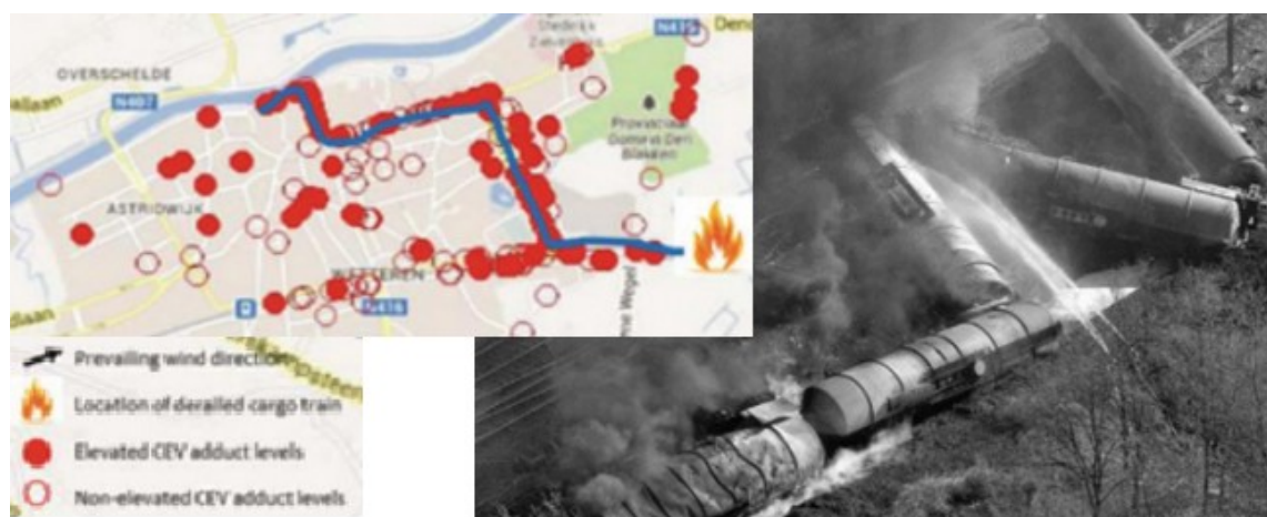
Fig. 20. Déraillement et feu de wagons d'acrylonitrile à Wetteren, Belgique, le 4 mai 2013. Une étude plus tardive montrera que les personnes les plus marquées sont le long de l'évacuation des eaux (Armon et Hänninen 2015 fig. 54.2; Pasman 2015, p. 9)
